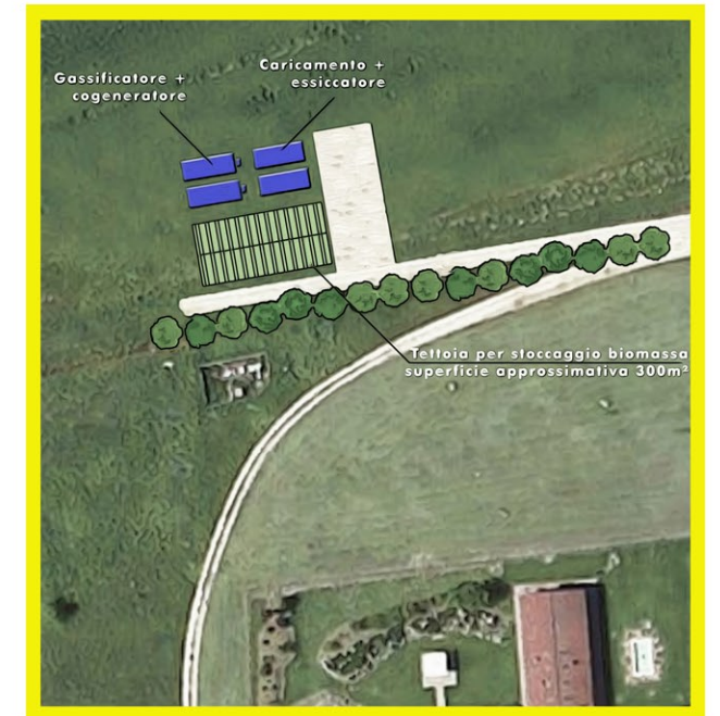
LAYOUT IMPIANTO DI COGENERAZIONE A SYNGAS
